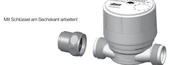
Achtung: Bei Montage von nur einer Verschraubung diese auf den Einlaufstutzen montieren (siehe Fliessrichtungspfeil).
