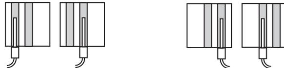
Beispiel Vermaßung vom Strom - Netzanschluss zur Endlage des Elektroheizstabes! Achtung, ggf. Verwendung von einem ME - Ventil beachten  $\Delta h = 71 \text{ mm}$
