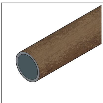
Erhebungen, Beschädigungen, Riefen, Korrosion oder lose Anhaftungen
