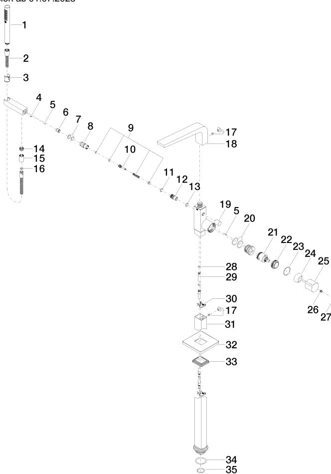
**CL.1 Wannen-Einhandbatterie mit Standrohr für freistehende Montage mit
