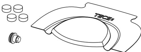
Per utilizzare il set disincrostante c'è bisogno di una chiave a brugola da 2,5 mm, una chiave a tubo con dado da 17 mm, una pinza ad ago e un termometro (opzionale). Per garantire la sicurezza dell'operatore, si consiglia di indossare guanti e occhiali di sicurezza.
