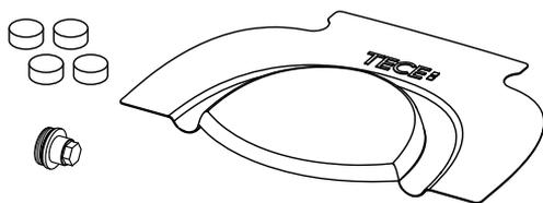
要使用该除垢套件，您需要一把 2.5 mm 内六角扳手、一把带有 17 mm 螺母的套筒扳手、尖嘴钳和一支温度计（选件）。为安全起见，我们建议您佩戴手套和护目镜。
