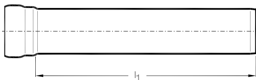
LORO-X Rohr mit einer Muffe, DN 100, ohne Innenbeschichtung
