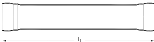
LORO-X Rohr mit zwei Muffen, DN 100, als Passtück zum Ablängen, ohne Innenbeschichtung Art.-Nr. 00120.100Q Gewicht: 5,1 kg
