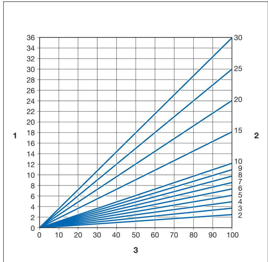
**Abb. 3: Längenausdehnung Stahlrohre**
