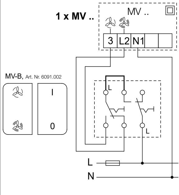
**SS-845.1** Anschluss von zwei Ventilatoren
