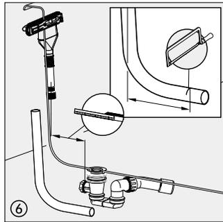
⑤ Ablaufbogen an den Geruchverschluss anschließen. Der Anschlussbogen kann wahlweise mit  $\varnothing 40$  oder  $\varnothing 50$  mm angeschlossen werden.
