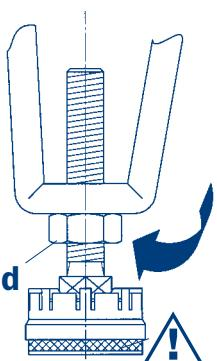
Retourner la baignoire, la mettre de niveau avec un niveau à bulle en tournant les vis et serrer le contre-écrou (d). Une installation effectuée correctement à l'aide du kit d'insonorisation Kaldewei respecte les exigences de la norme DIN 4109/A1.
