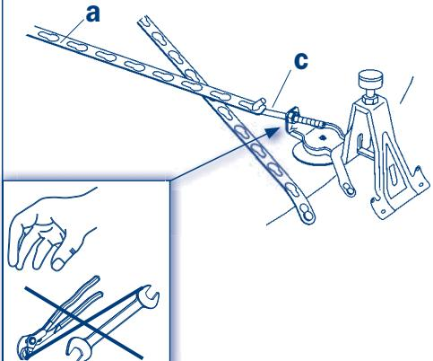
**4. Wanne umdrehen, ausrichten und Kontermutter (d) anziehen.**
