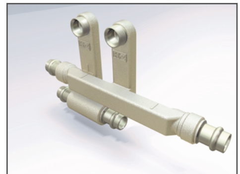
Abb. 1: HZ-HKU, Artikel 1445, Heizkörperanschluss zum Pressen für Metallrohre, V-Kontur
