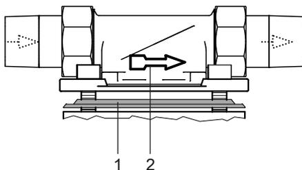
Abb. 2: Einbaudrehflansch
