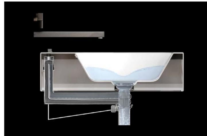
Der Drehknopf wird wieder in die Ausgangslage zurückgedreht, und das Ablaufventil ist wieder geöffnet. Das Wasser wird nicht mehr gestaut und fließt ab.
