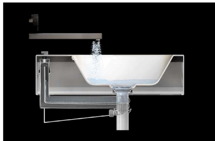
Das Ablaufventil wird durch den Drehknopf oder durch Betätigung der Excenterstange geschlossen und die Überlauffunktion des CLOUs wird aktiviert. Das Wasser wird im Waschtisch gestaut.
