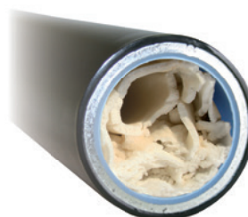
Unhygienisch: verkalktes Verbund- rohrsystem
