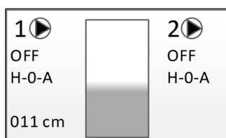
Sur l'affichage standard, la commande indique le mode de fonctionnement, l'état de commutation, le courant moteur et le niveau.
