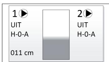
In de standaardweergave toont het besturingssysteem de bedrijfsmodus, de schakeltoestand, de motorstroom en het niveau.
