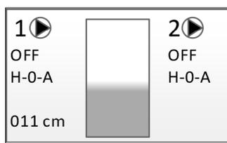
Na wyświetlaczu standardowym widoczny jest tryb pracy, stan ładowania, prąd silnika i poziom.
