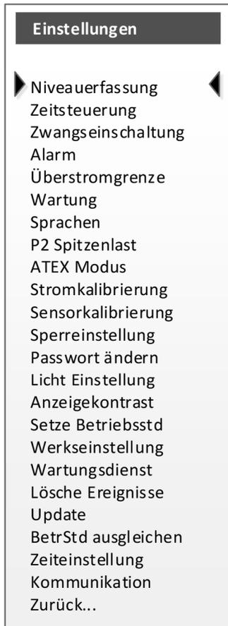
Soll in diesem Menü ein Parameter geändert werden, so wird zur Eingabe eines 4-stelligen Passwortes aufgefordert.
