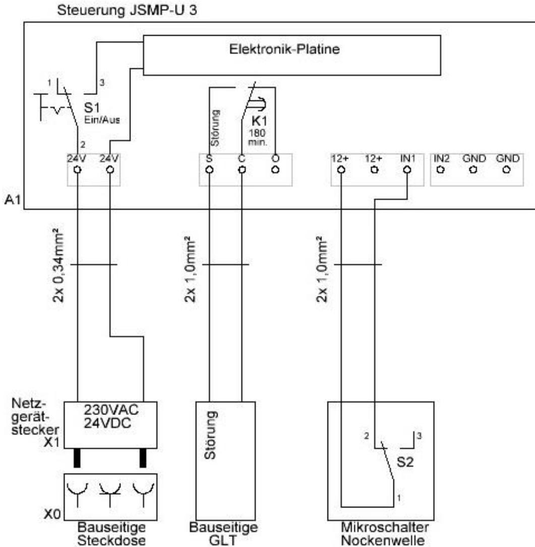
Abb. 6: Elektrischer Anschluss JSMP-U 3
