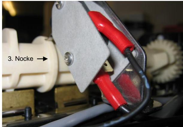
Abb. 2: Störmeldekkit (Mikroschalter) Nockenwelle
