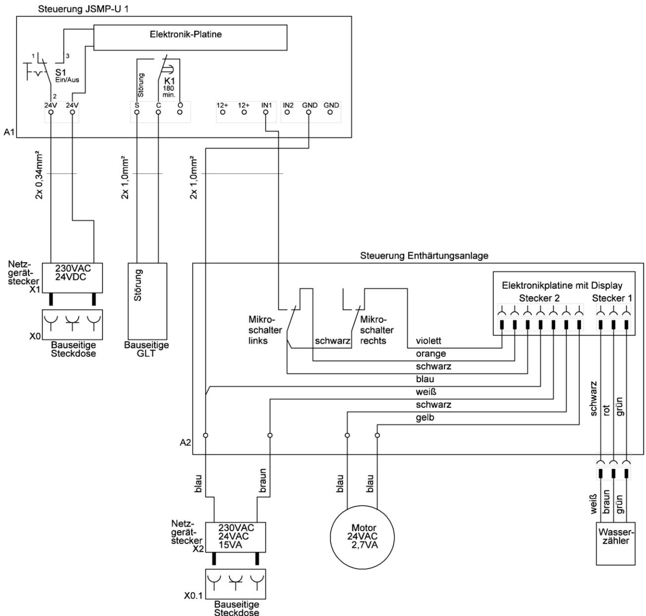
Abb. 5: Elektrischer Anschluss JSMP-U 1
