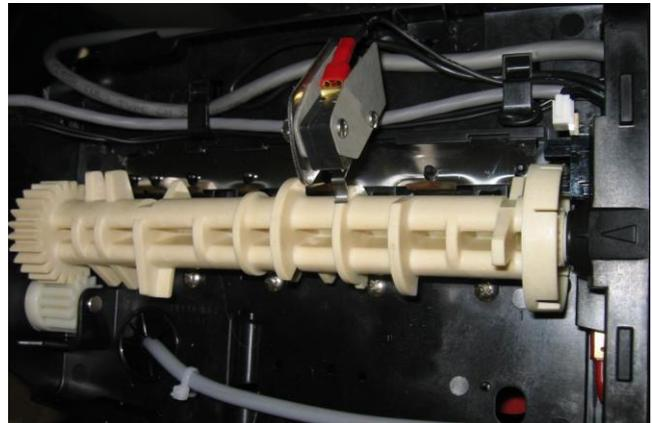
Abb. 3: Störmeldekkit (Mikroschalter) Nockenwelle (von oben)
