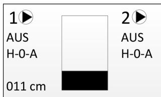
In der Standardanzeige zeigt die Steuerung Betriebsart, Schaltzustand, Motorstrom und das Niveau.
