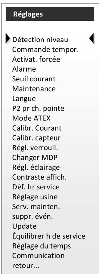
Si un paramètre doit être changé dans ce menu, la saisie d'un mot de passe à 4 chiffres est exigée.
