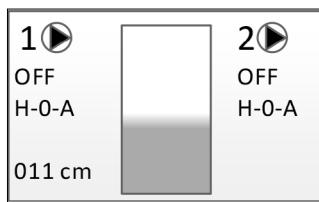
Na wyświetlaczu standardowym widoczny jest tryb pracy, stan łączniowy, prąd silnika i poziom.
