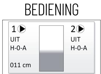
In de standaardweergave toont het besturingssysteem de bedrijfsmodus, de schakeltoestand, de motorstroom en het niveau.
