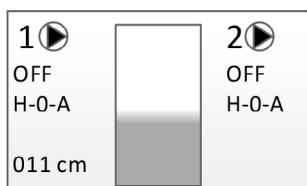
In visualizzazione standard il comando mostra la modalità operativa, lo stato di commutazione, la corrente del motore e il livello.
