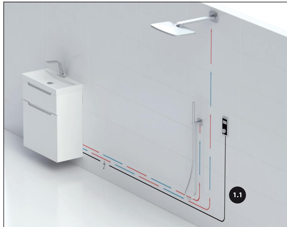
**1.1** Kunststoffrohr unter Putz für Steuerungskabel (Mini-DIN) zwischen Einstell- und Bedieneinheit verlegen (Kunststoffrohr nicht im Lieferumfang enthalten).
