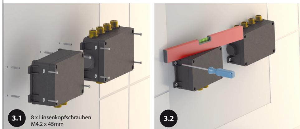
3.1 Befestigungslöcher bohren und Dübel setzen
