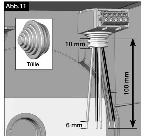
Das Anschlusskabel ist so zu verwahren, dass bei Wasserbeaufschlagung kein Wasser entlang des Kabels eindringen kann. Das Kabel darf nicht über scharfe Kanten geführt werden!
