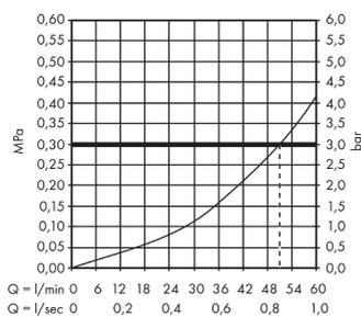
**Grundkörper 52 l/min für Abstellventil Unterputz Spindel DN15**
