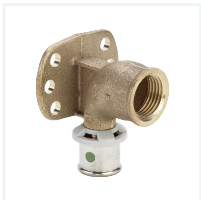
Sanfix P-Wandscheibe mit SC-Contur - Pressanschluss, Rp-Gewinde Modell 2125.5
